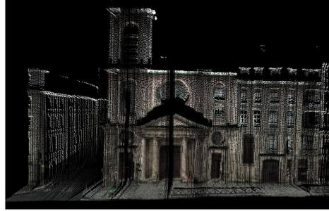
Figure 11: Résultats de la colorisation des points laser à l'aide de la caméra fish-eye
