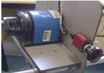
**Figure 2:** Système de vision couplé
